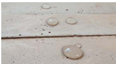
Il bassissimo assorbimento d'acqua proveniente sia da pioggia battente che da risalita capillare limita notevolmente la propagazione delle efflorescenze saline.
